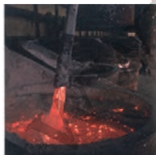
● آلومینیم مذاب تولید شده در فرایند هال
