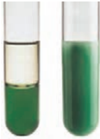
شکل ۱- کلوئید پایدار شده آب و روغن با استفاده از صابون (البته برای نمایش بهتر به آب دو قطره رنگ افزوده شده است).
